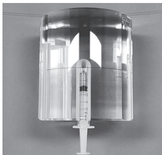
Fig. 1 甲状腺ファントム 真上から見たポリプロピレン製シリンジの挿入位置
