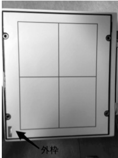
Fig. 7 当院従来機種の検出器の様子。矢印に示す外枠部分が半導体検出器のそれと比べ厚い。
