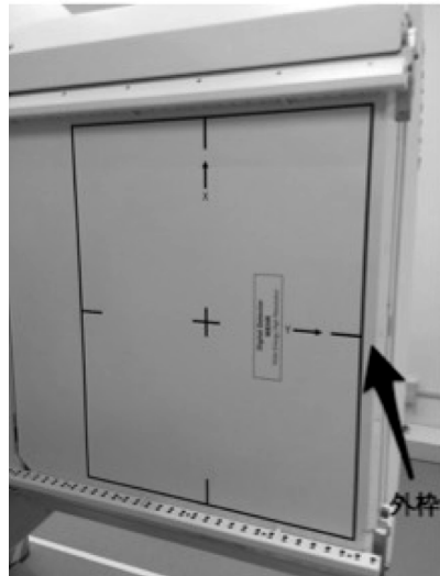
Fig. 8 Discovery NM/CT 670 CZT の検出器の様子。矢印に示す外枠部分が薄く出来ている。
