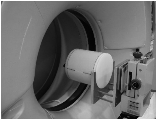
ファントム設置
